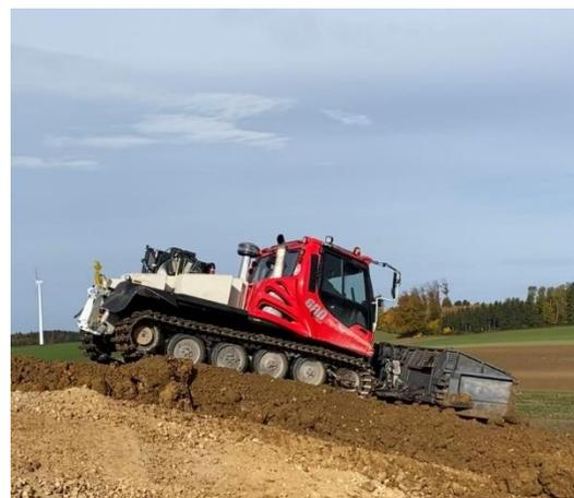
Der PistenBully 600 wurde für die Piste entwickelt. Doch durch sein geringes Eigengewicht und der großen Auflagefläche eignet er sich perfekt für bodenschonende Arbeiten. Er kommt überall dort zum Einsatz wo die Schonung des Untergrundes im Vordergrund steht.
